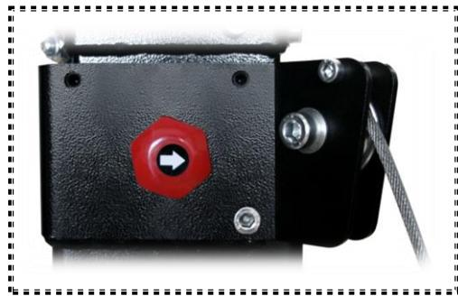
2.- Потяните и удерживайте предохранительный болт в этом положении и поверните рукоятку лебёдки, опуская телескопическую секцию.
