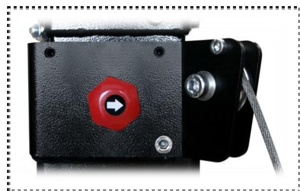
2.- Поверните ручку лебедки, подняв эту телескопическую секцию, которая автоматически заблокируется, когда достигнет верха.
